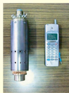
⑬遠心式ヘリウム汲上ポンプ 20 L/min 120rpm
