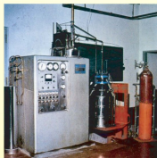
▲コリンズ式 ヘリウム液化機 Model200-C
