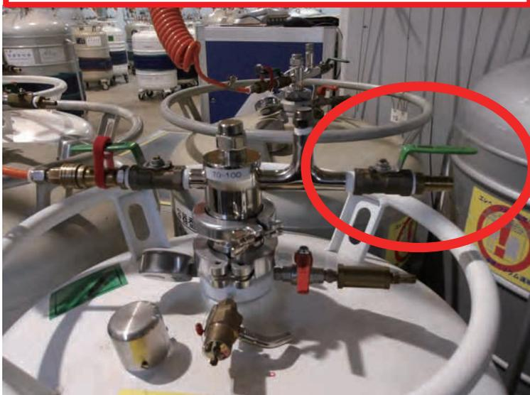
栓が付いていないので、ガスが大気放出されている。容器だけでなく回収ラインのガスも全て放出されている。
