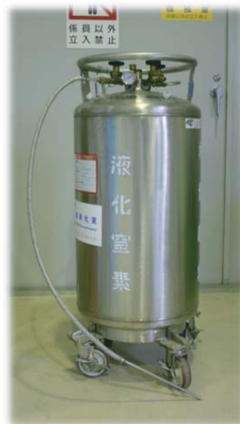
図1 自加圧型の液化室素容器
