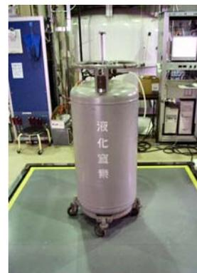
図1 自加圧型液体窒素容器の例
