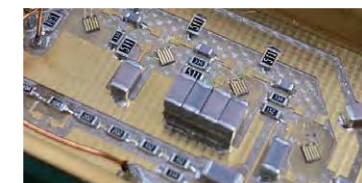
自作の低温量子測定回路 (MHz帯域で世界最高精度)
