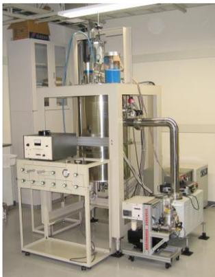
蒸着用断熱型熱量計(柏)
