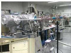
分子線エピタキシー装置と電子線リソグラフィ装置
