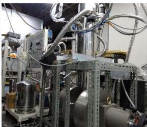
無冷媒希釈冷凍機と電磁石
