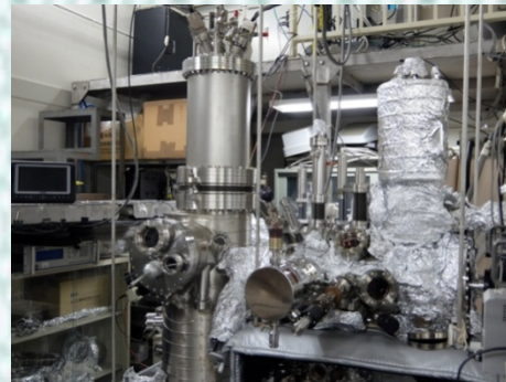
極低温STM装置2:液体ヘリウム、液体窒素で冷却するSTM。各種表面の原子配列、ナノ構造観察、トンネル分光、準粒子干渉観察を行っている。
