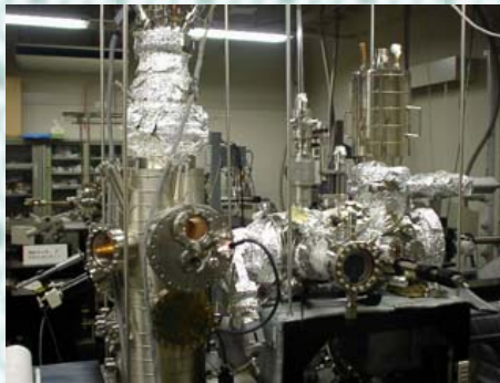
極低温STM装置1:液体ヘリウム、液体窒素で冷却するSTM。各種表面の原子配列、ナノ構造観察、トンネル分光を行っている。
