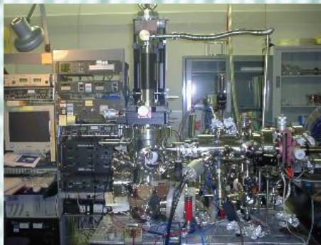
磁気カー効果測定装置:金属表面上の強磁性ナノ構造や強磁性超薄膜の磁性を調べている。
