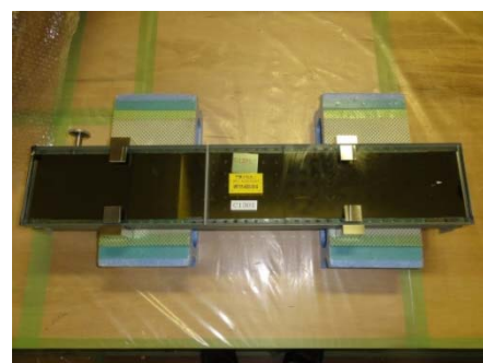
写真 2 : Ni/Ti 多層膜 スーパーミラー
