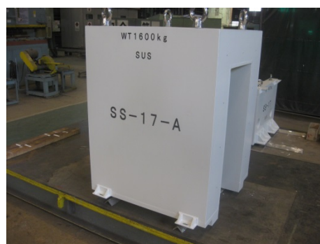
写真 7 : 新導管遮蔽体
