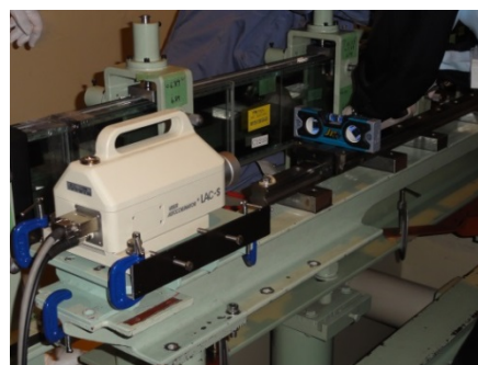
写真3：オートコリメータ法による接合角測定
