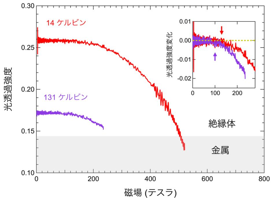
図1.  $V_{1-x}W_xO_2$  ( $x=0.06$ ) 薄膜 (膜厚 15 ナノメートル、 $TiO_2$  基板) のレーザー波長  $1.977\ \mu\text{m}$  での光透過強度の磁場依存性。14 ケルビンの温度では約 500 テスラで絶縁体から金属に変化することが捉えられました。挿入図は、磁場による透過光強度変化分を磁場の関数でプロットしています。温度にあまり依存せず、100 テスラ近傍から金属化への変化が起こることから、この相転移にはしきい磁場があることが分かります。
