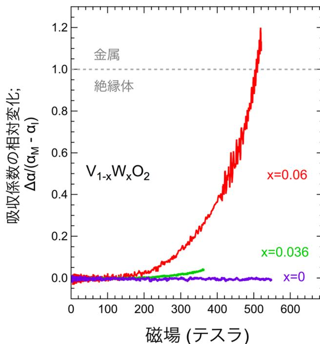
図2.  $V_{1-x}W_xO_2$  ( $x=0, 0.036, 0.06$ )薄膜における、吸収係数  $\alpha$  の相対変化量の磁場依存性。 $\alpha_M$ 、 $\alpha_I$ はそれぞれ、ゼロ磁場における高温金属状態と低温絶縁体状態の吸収係数。 $x=0$ では540テスラまで磁場による金属化は観測されることがわかりました。 $x=0.036$ では、実験時の磁場発生装置の放電スイッチ同期不良により、最高磁場が360テスラまでに制限されましたが、金属化開始の兆候が200テスラ付近から観測されています。
