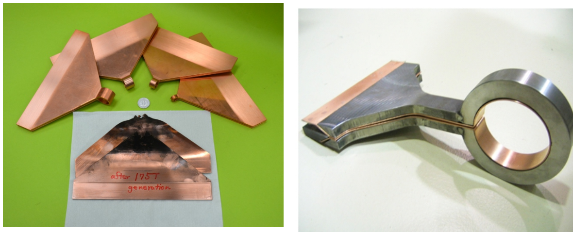
図1. 一卷きコイル法(左)と電磁濃縮法(右)に使用される電磁石の写真。左図では、磁場発生後に爆発したコイルを一緒に写しています。
