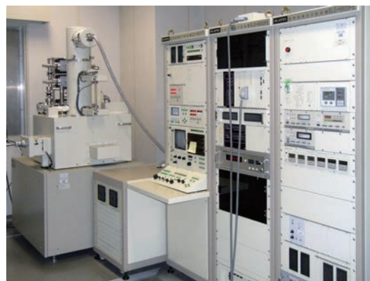
電子線リソグラフィー装置 (エリオニクス)。最高加速電圧は75 kV。ビーム径は2 nm。
