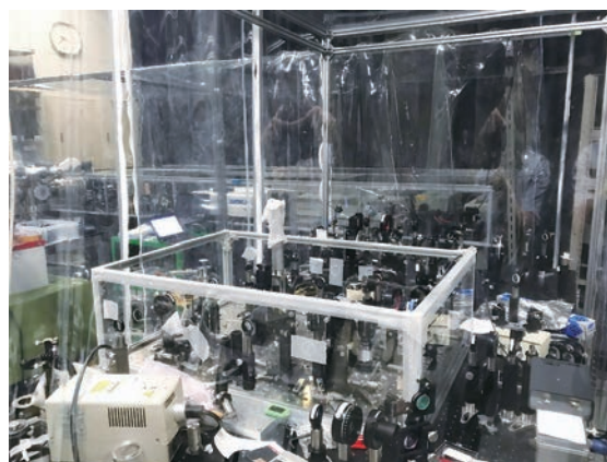
テラヘルツ電磁応答および Hall 伝導測定に用いる透過・反射・偏光回転精密計測システム
