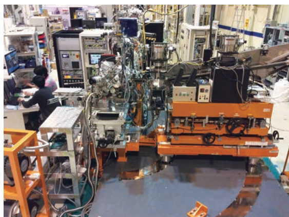
当研究室がSPring-8で独自に開発した50 meVの高エネルギー分解能を持つ角度分解軟X線発光分光装置。2024年4月よりNanoTerasuで稼働する。
