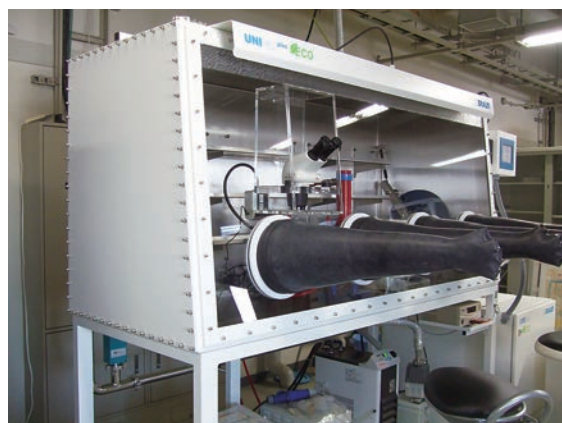
試料調整用グローブボックス Glove box for sample preparation
