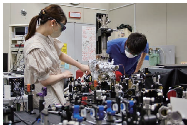
THz パルス駆動表面反応装置 (松永研究室との共同研究)
