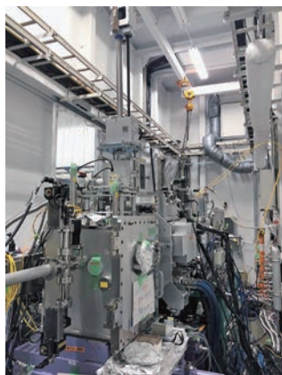
X 線自由電子レーザー施設 SACLA に設置された高分解能コヒーレント回折イメージング装置。多層膜集光ミラーで集光された高強度 X 線パルスにより、最高で 2 nm 分解能でのイメージングが可能となっている。
