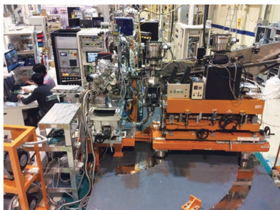
当研究室が SPring-8 の東京大学放射光アウトステーションビームライン BL07LSU で独自に開発した 50 meV の高エネルギー分解能を持つ角度分解軟X線発光分光装置。
