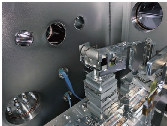
軟 X 線のナノ集光に利用するウォルターミラー光学系。 Wolter mirror optics for soft X-ray nano focusing.
