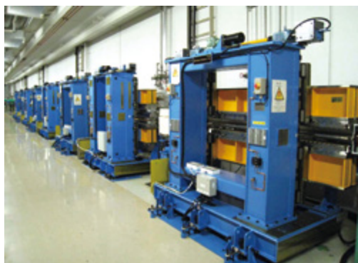
SPring-8 BL07LSU の 8 台の Figure-8 アンジュレーター。本挿入光源より連続偏角可変型不等間隔刻線平面回折格子分光器を経て、各実験ステーションに高輝度軟 X 線が供給される。
