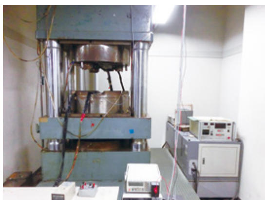
若槻型 700ton キュービックプレス。4GPa までの高温高圧合成実験用。
