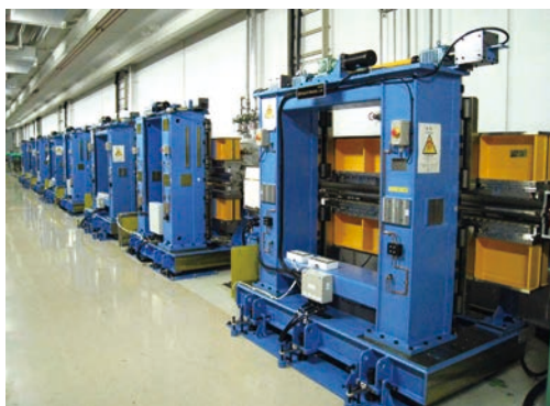
SPring-8 BL07LSU の 8 台の Figure-8 アンジュレター。本挿入光源より連続偏角可変型不等間隔刻線平面回折格子分光器を経て、各実験ステーションに高輝度軟 X 線が供給される。
