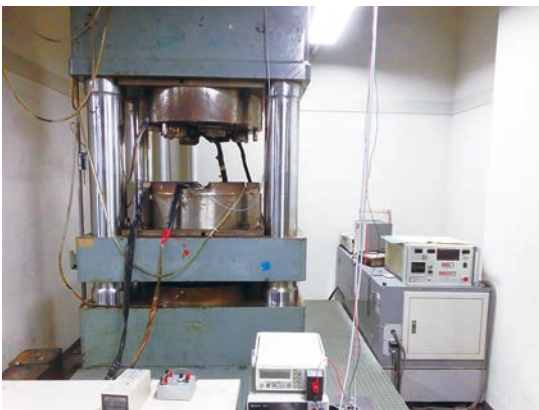
若槻型 700ton キュービックプレス。4GPa までの高温高圧合成実験用。
