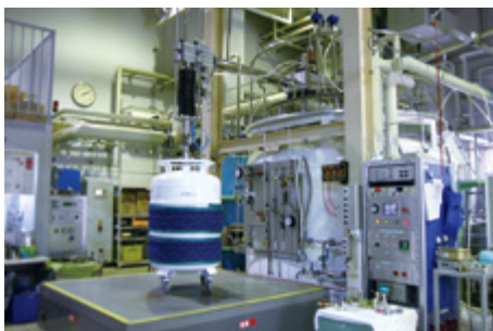
ヘリウム液化機、貯槽及び遠心汲み上げポンプ Helium liquefier, storage, and transfer system
