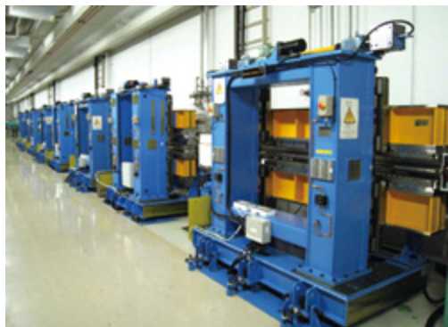
SPring-8 BL07LSU の 8 台の Figure-8 アンジュレター。本挿入光源より連続偏角可変型不等刻線間隔平面回折格子分光器を経て、各実験ステーションに高輝度軟 X 線が供給される。
