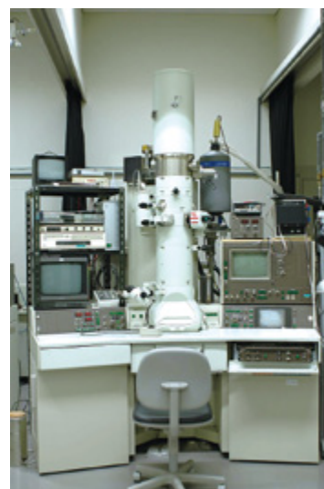
200 kV 電界放射形分析電子顕微鏡
