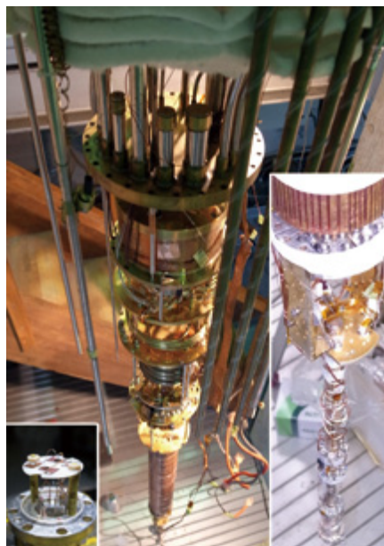
物性研の核断熱消磁冷凍機。超低温 (1 mK)・高磁場 (10 T) の実験が可能。右下挿図が実験空間拡大写真。左下挿図が超低温トルク測定用カンチレバー。
