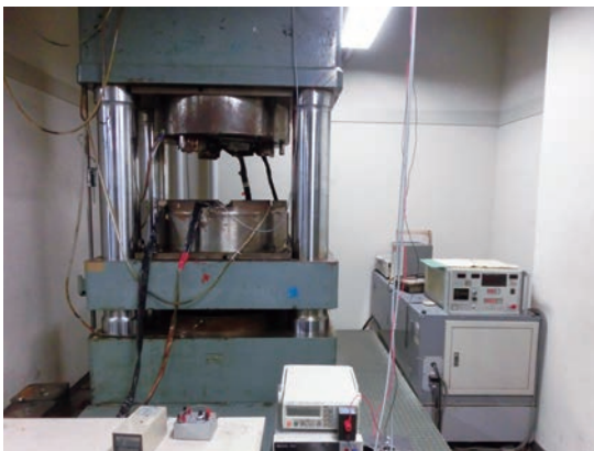
若槻型 700ton キュービックプレス。4GPa までの高温高压合成実験用。
