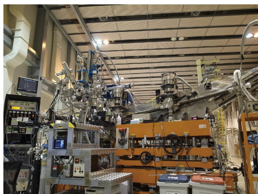
当研究室が SPring-8 の東京大学放射光アウトステーションビームライン BL07LSU で独自に開発した 50 meV の世界最高エネルギー分解能を持つ軟X線発光分光装置。
