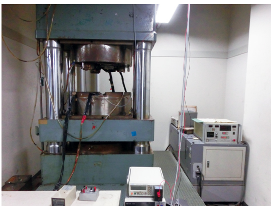
若槻型 700ton キュービックプレス。4GPa までの高温高压合成実験用。
