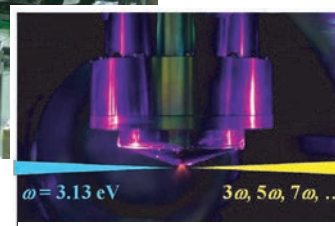
高次高調波発生を用いた軟 X 線レーザー時間分解光電子分光装置。
