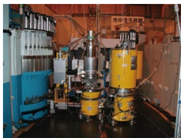
日本原子力研究開発機構 (JAEA) の研究炉 JRR-3 に設置された物性研究所の 3 軸型中性子分光器。
