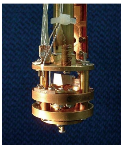
極低温ファラデー磁力計に用いるキャパシタンス荷重計。最低温30 mKで17 Tまでの磁化測定が可能である。
