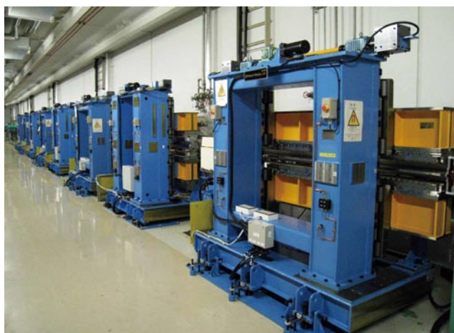
SPring-8 BL07LSU の 8 台の Figure-8 アンジュレーター。本挿入光源より連続偏角可変型不等刻線間隔平面回折格子分光器を経て、各実験ステーションに高輝度軟X線が供給される。
