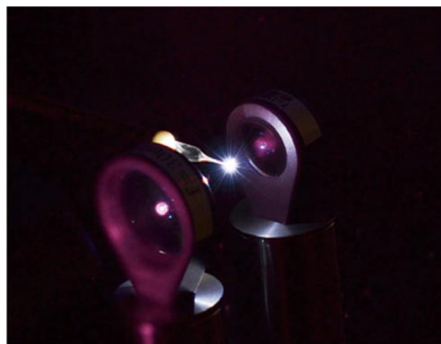
高繰り返しレーザーによる希ガスプラズマ Xe plasma generated by multi-MHz laser system.
