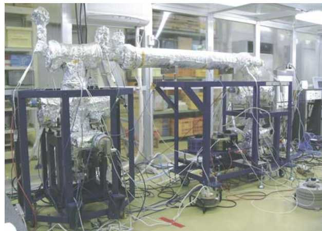
内面を銅メッキされたステンレス製真空チェンバーの超高真空試験用セットアップ。 Setup of ultra-high vacuum test for copper-coated stainless steel chamber.
