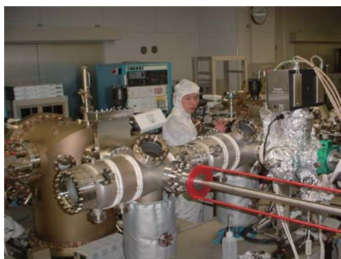
高品質半導体超薄膜を成長するための分子線エピタキシー装置。 Molecular beam epitaxy machine to grow high quality ultra-thin films of semiconductors.
