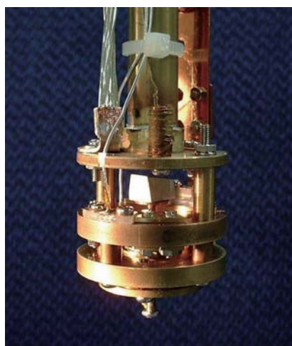
極低温ファラデー磁力計に用いるキャパシタンス荷重計。最低温30 mKで15 Tまでの磁化測定が可能である。
