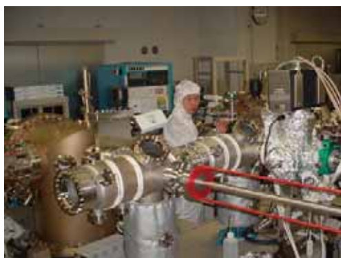
高品質半導体超薄膜を成長するための分子線エピタキシー装置。 Molecular beam epitaxy machine to grow high quality ultra-thin films of semiconductors.
