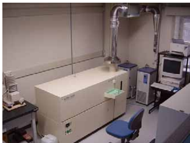
プラズマ発光分析装置：少量の試料に含まれる元素を極めて高い精度で定量分析できる。
