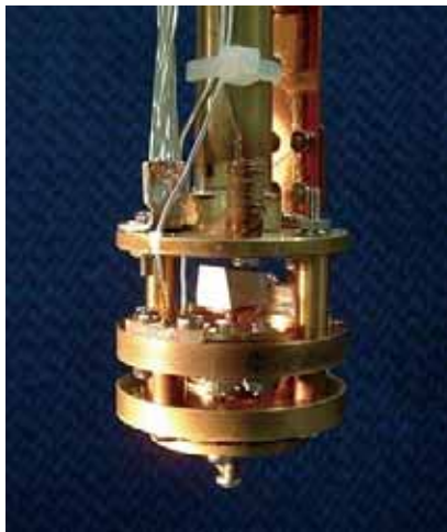
極低温ファラデー磁力計に用いるキャパシタンス荷重計。最低温 30 mK で 15 T までの磁化測定が可能である。
