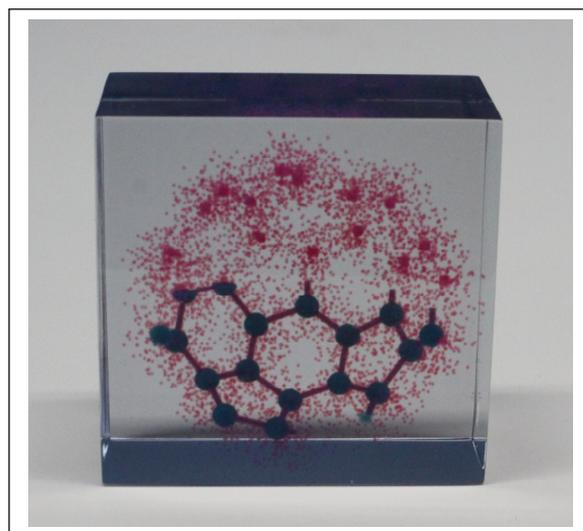
図 2 3D プリンタで透明樹脂中に形成した、フラレン(C<sub>60</sub>)の電子雲を描写した分子模型(5cm 角)。図 1 のデータを用いて作製した。
