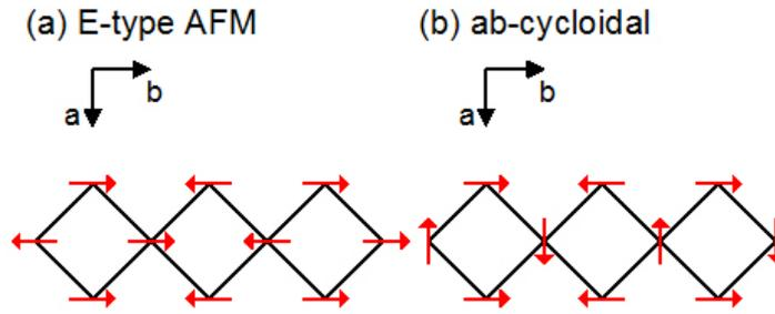
図2 : YMnO<sub>3</sub>/YAlO<sub>3</sub>(010)薄膜の ab 平面における Mn のスピン(矢印)秩序の様子。
