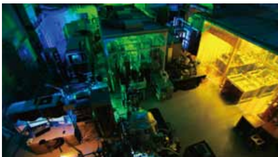
高強度チタンサファイアレーザー によるコヒーレント軟 X 線光源 (高次高調波) を用いた時間分解 光電子分光装置
