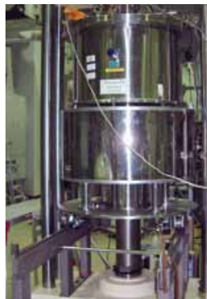
キュービックアンビル圧力発生装置。12 万気圧以上の超高压を低温強磁場と組み合わせた多重極限環境下での物性測定を行う事が出来る。Cubic anvil high-pressure apparatus. Cryostat for experiment under multiple extreme conditions of low temperature, high magnetic field, and high pressure.
