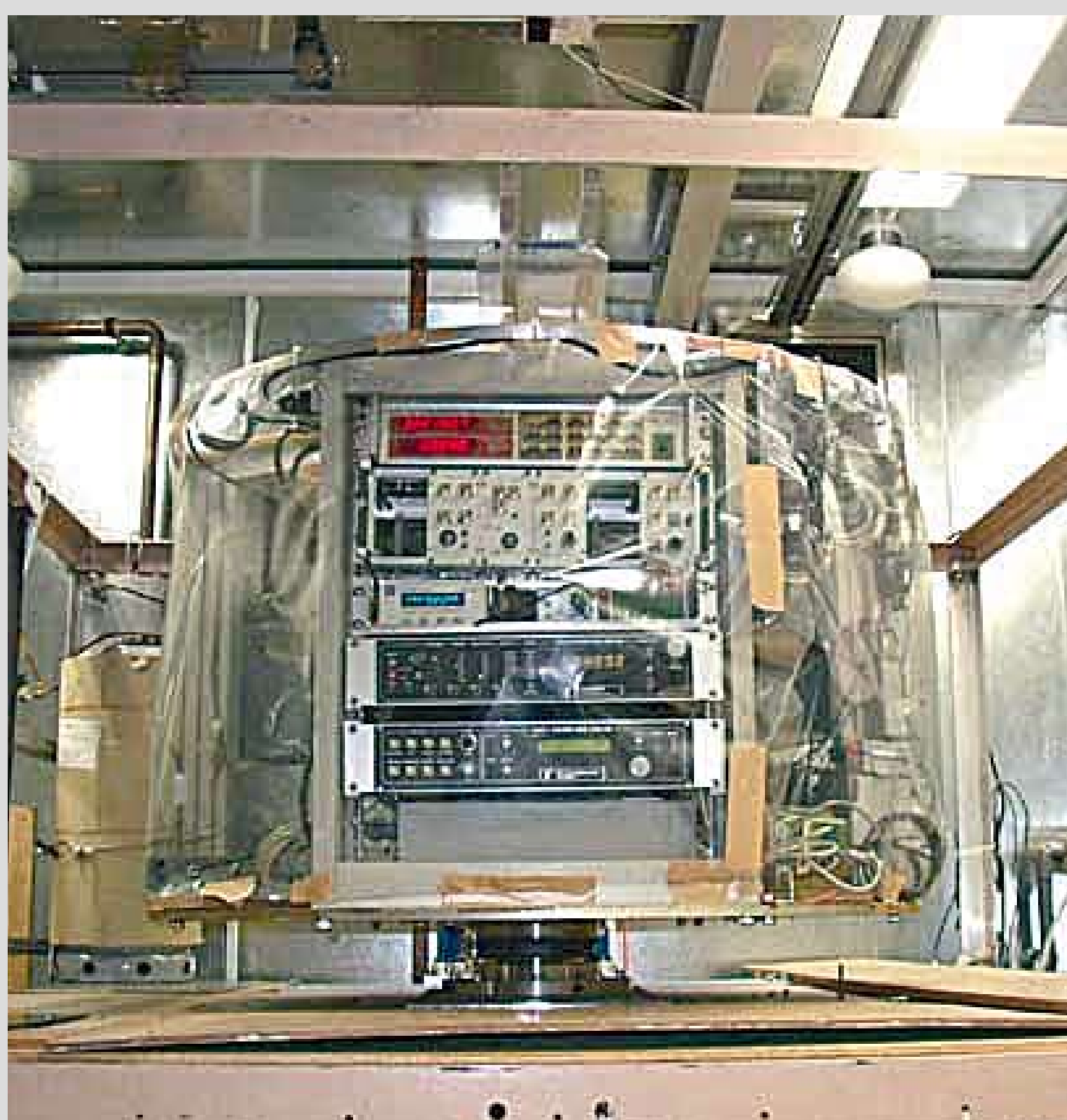
核断熱消磁法による超低温生成装置。この装置によって10 6 K、15 Tという世界最高水準の極限環境が得られる。 Large nuclear demagnetization refrigerator for experiments in world-record-class extreme condition, down to 10 6 K and up to 15 T.
