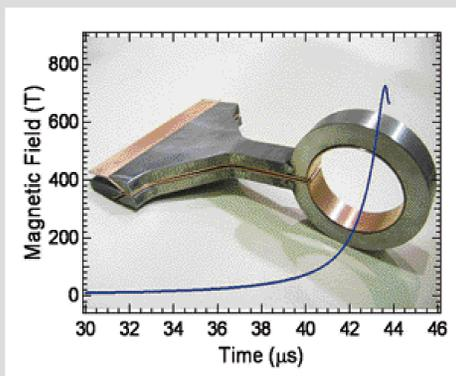
電磁濃縮磁場発生に用いる主コイルと磁場濃縮時間発展。
