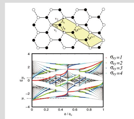
磁場  $\phi$  の下における2次元六角格子上の電子のエネルギー  $E$  と量子ホール係数  $\sigma_{xy}$ 。
