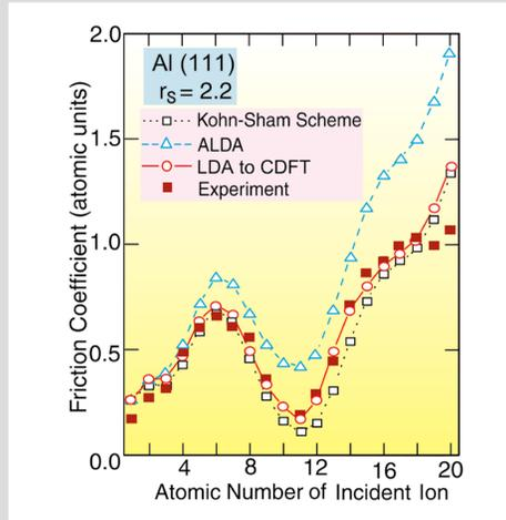
Al薄膜と低速入射イオンの摩擦係数の第一原理計算は殻構造を反映した振動を含めて実験をよく再現する。
