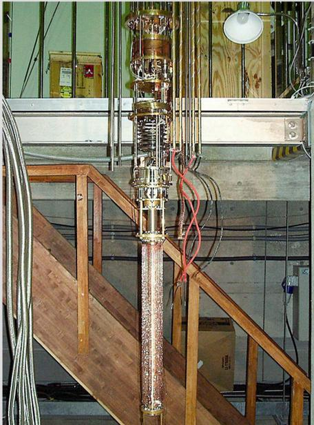
核断熱消磁法による超低温生成装置。この装置によって10<sup>6</sup> K、15 Tという世界最高水準の極限環境が得られる。
