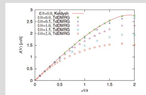
時間依存密度行列繰り込み群を用いて計算した量子ドットを介して流れる非平衡定常状態の電流。
