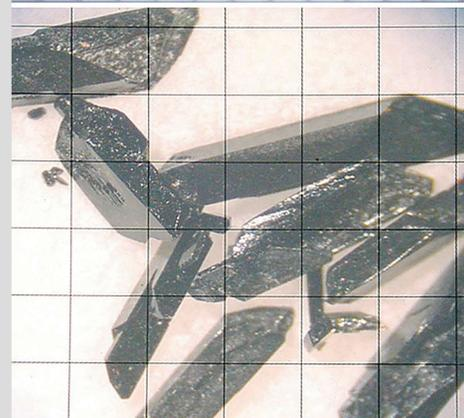
有機超伝導体  $\kappa$ -(BEDT-TTF)<sub>2</sub>Cu(NCS)<sub>2</sub> の定電流電解結晶育成とその単結晶。
