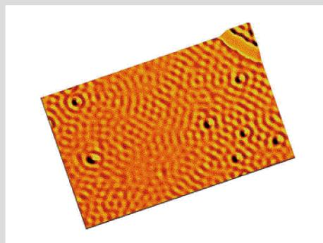
走査型トンネル顕微鏡を用いて銅表面で観察される電子定在波。
