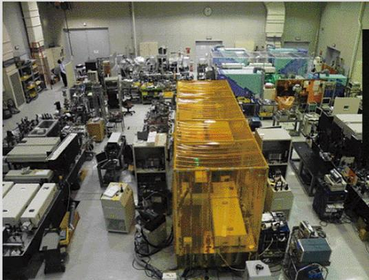
高強度チタンサファイアレーザーによるコヒーレント軟X線光源(高次高調波)。
