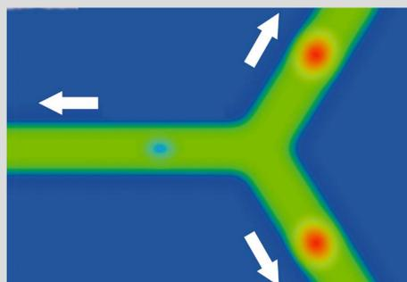
1次元ボース凝縮体のY字型接合における負の密度の反射。
