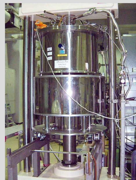
キュービックアンビル圧力発生装置。12万気圧以上の超高圧を低温強磁場と組み合わせた多重極限環境下での物性測定を行う事が出来る。
