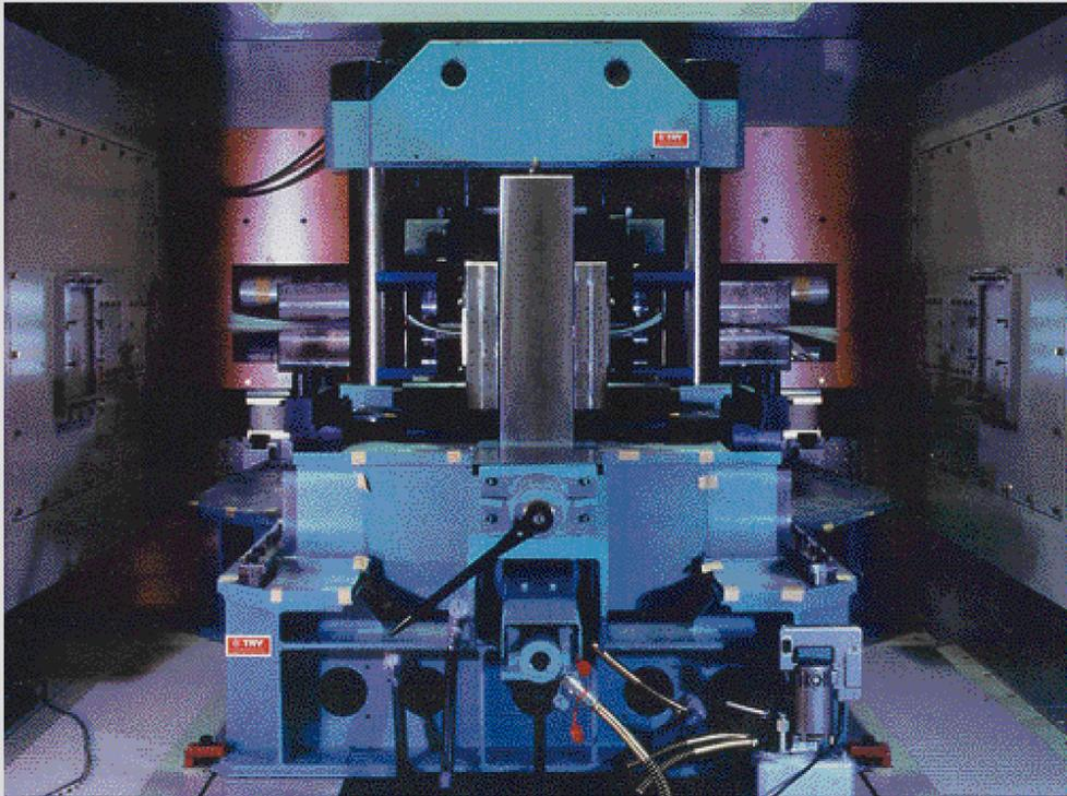
爆破保護室内に設置された「電磁濃縮法」による超強磁場発生装置。
