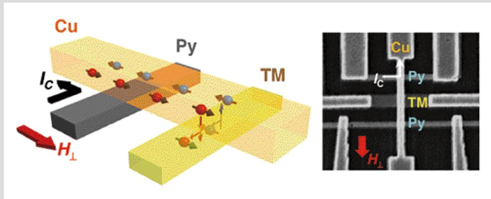
スピン吸収法を用いた遷移金属のスピンホール効果測定。
