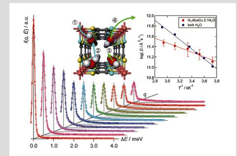
パルス冷中性子分光器(AGNES)によるルベアン酸銅水和物のプロトン伝導の研究。準弾性散乱スペクトル(左下)から拡散係数(右上)を計算し、プロトン伝導モデル(左上)との比較を行う。
