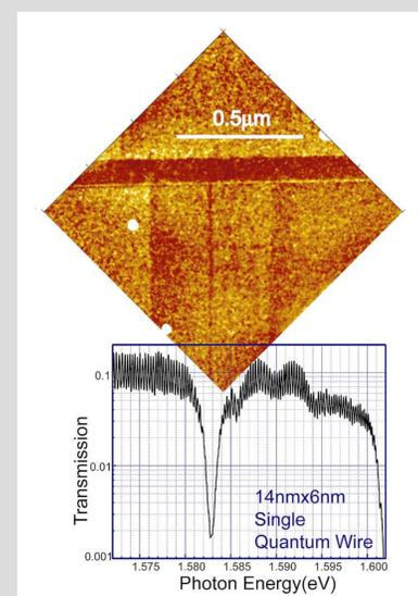
単一量子細線での光透過吸収実験。
