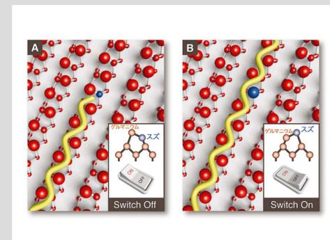
半導体表面上の原子対の傾きをパルス電流を用いて局所的に変化させ、表面を流れる電流をスイッチする。
