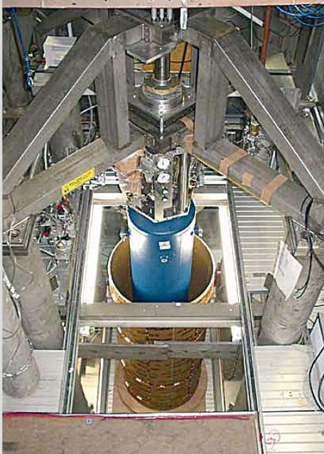
毎秒2回転までの定常回転状態の下で数百マイクロケルビン迄の超流動観測が行われている世界最高速の「ISSP超低温回転クライオスタット」。
