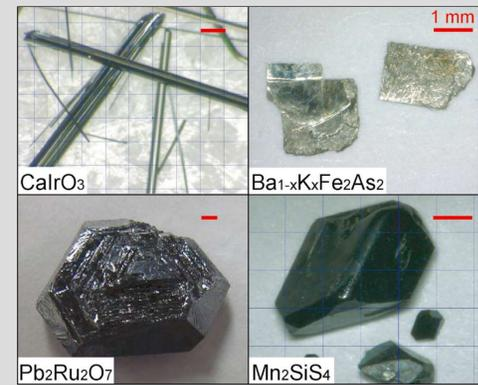
強相関電子物質の単結晶。ポストペロブスカイト型酸化物CaIrO<sub>3</sub>、高温超伝導体Ba<sub>1-x</sub>K<sub>x</sub>Fe<sub>2</sub>As<sub>2</sub>、反転対称性の破れた金属Pb<sub>2</sub>Ru<sub>2</sub>O<sub>7</sub>、オリビン型硫化物Mn<sub>2</sub>SiS<sub>4</sub>。
