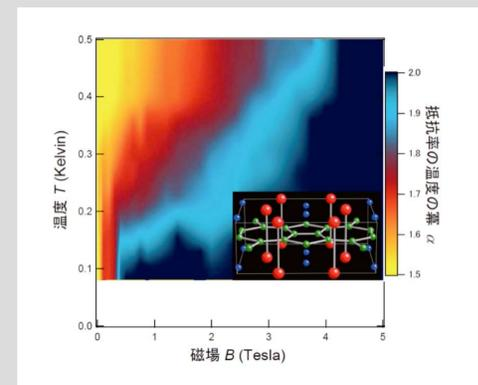
顕著な量子臨界性を示す重い電子系β-YbAlB<sub>4</sub>の温度・磁場相図と結晶構造。
