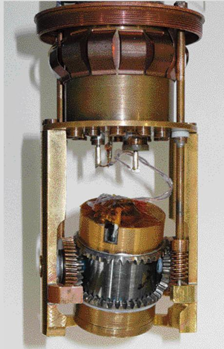
超高压下角度分解NMR測定プローブ。
