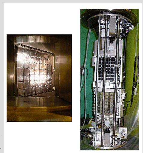
中性子散乱用2方向フォーカシングアナライザー、モノクロメータ。Doubly focusing analyzer and monochromator for neutron scattering.
