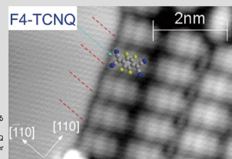
Cu(100)表面のステップ下端に選択的に吸着する強力なアクセプター分子F4-TCNQのSTM像。
