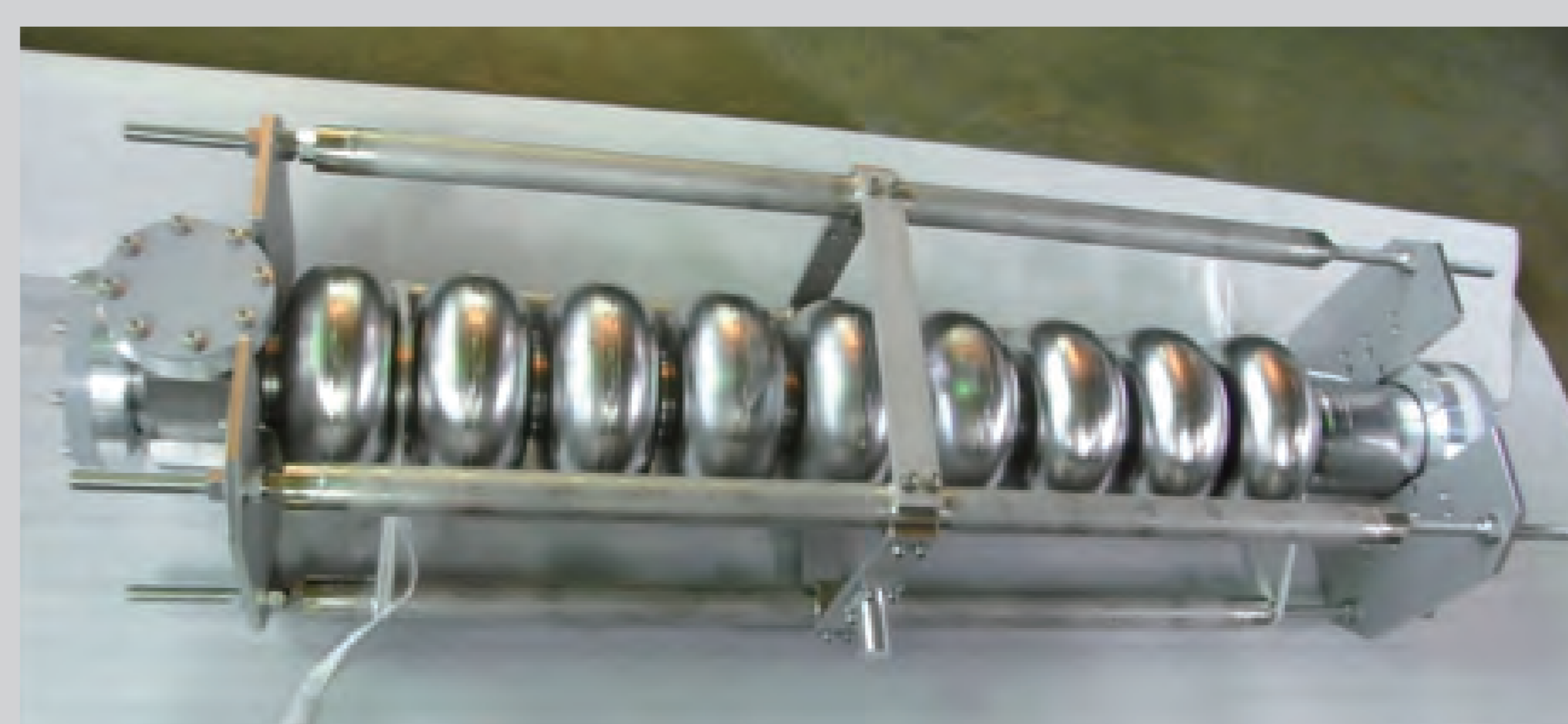
次世代放射光源のための超伝導加速空洞モデル。 Superconducting cavity for future light source.
