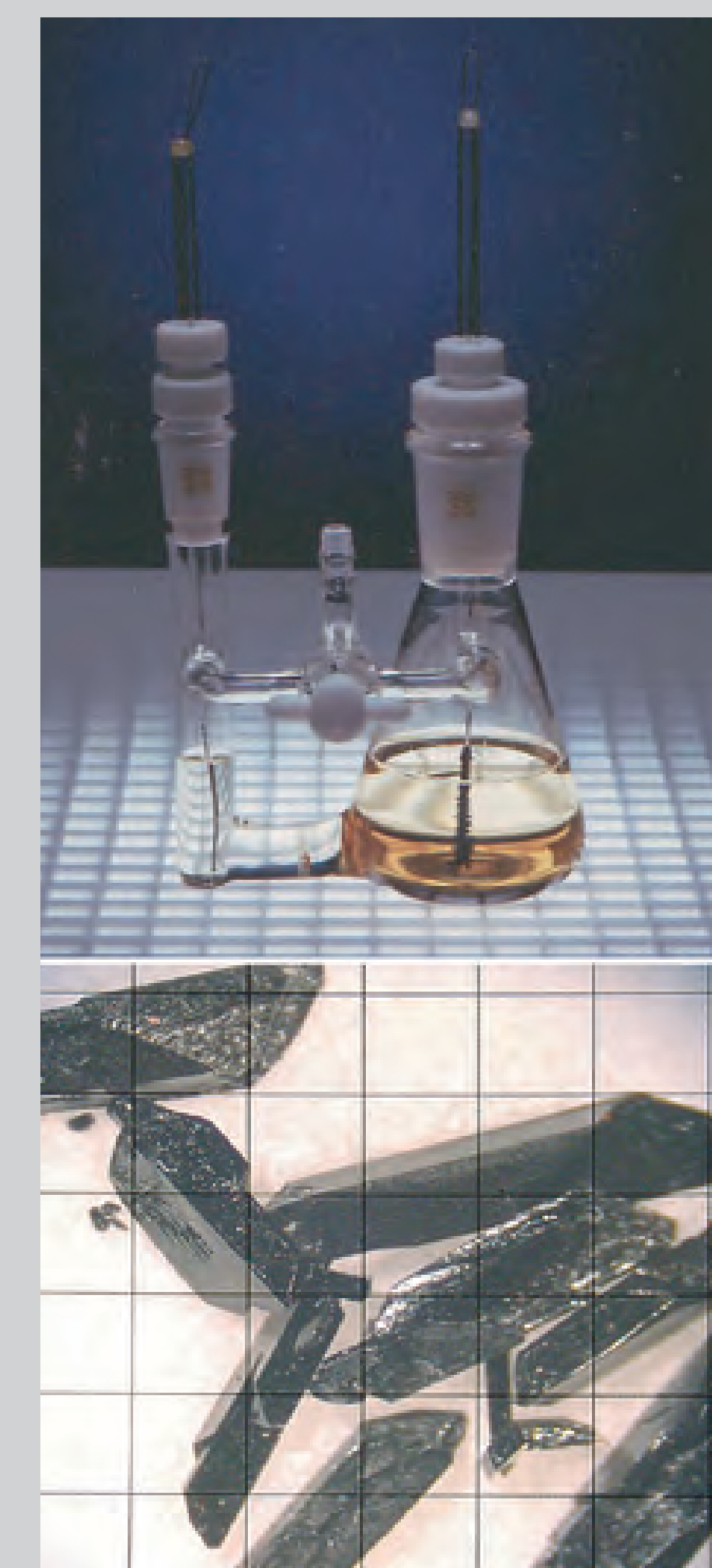
有機超伝導体 \kappa -(BEDT-TTF) 2 Cu(NCS) 2 の定電流電解結晶育成とその単結晶。 Electrocrystallization and single crystals of organic superconductor \kappa -(BEDT-TTF) 2 Cu(NCS) 2 .
