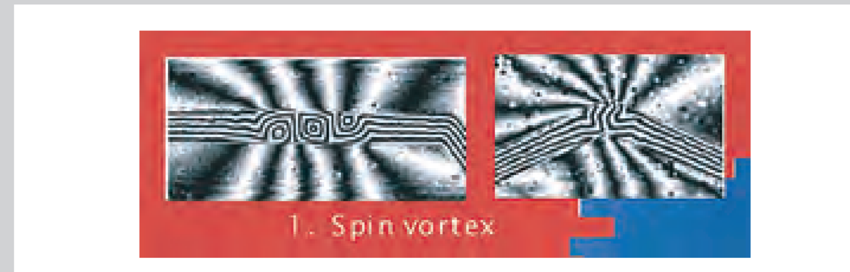
スピントポロジの電子線ホログラム パーマロイ強磁性ナノ細線中に生成したスピントポロジの電子線ホログラム。図中の黒と白の線の流れは磁力線の分布に相当する。 Electron holograms of spin vortices Electron holograms of spin vortices nucleated in ferromagnetic permalloy nano wires 500 nm wide and 30 nm thick. Black and white lines in the figures correspond to the magnetic flux lines.
