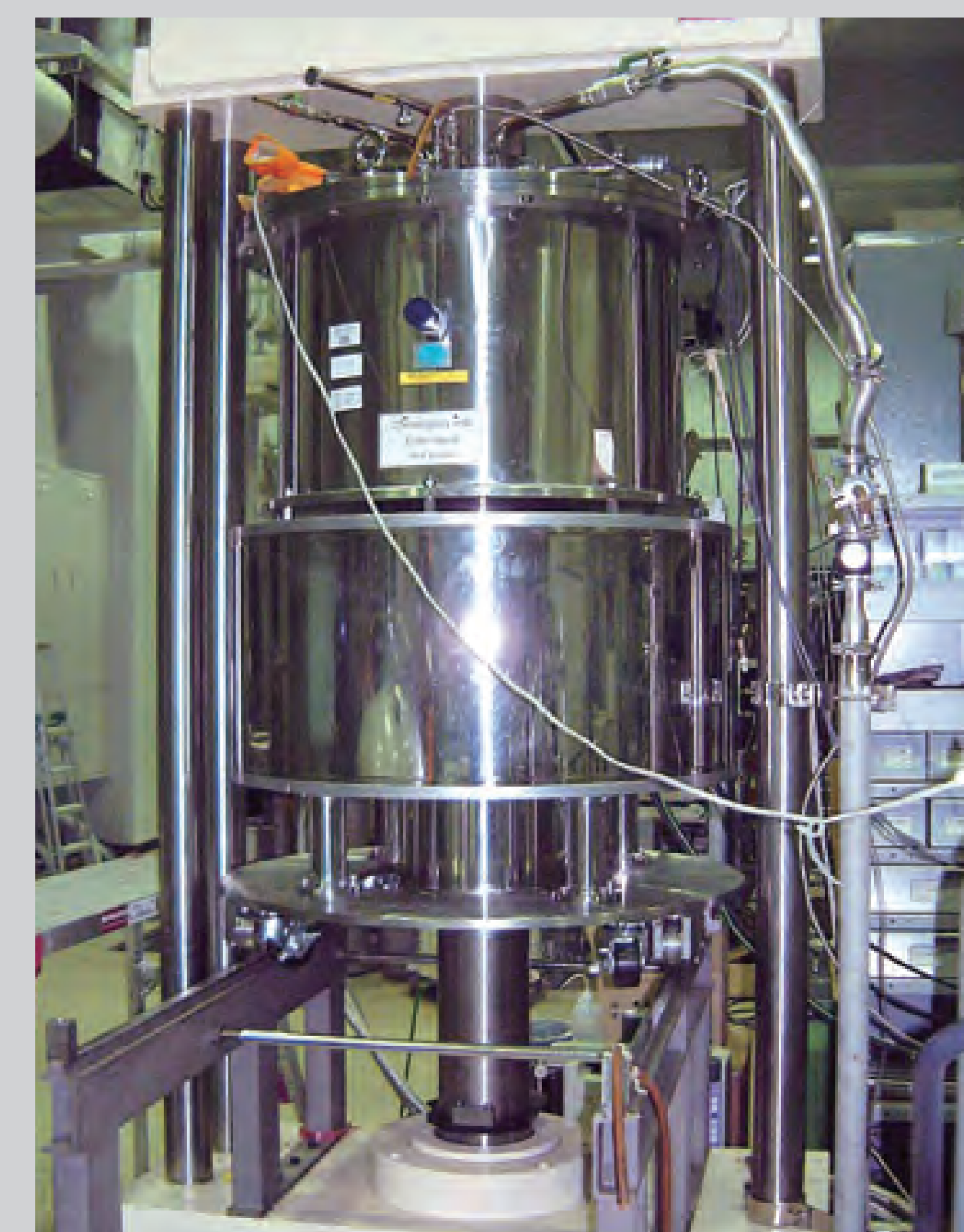
キュービックアンビル圧力発生装置。12万気圧以上の超高圧を低温強磁場と組み合わせた多重極限環境下での物性測定を行う事が出来る。 Cubic anvil high-pressure apparatus. Cryostat for experiment under multiple extreme conditions of low temperature, high magnetic field, and high pressure.
