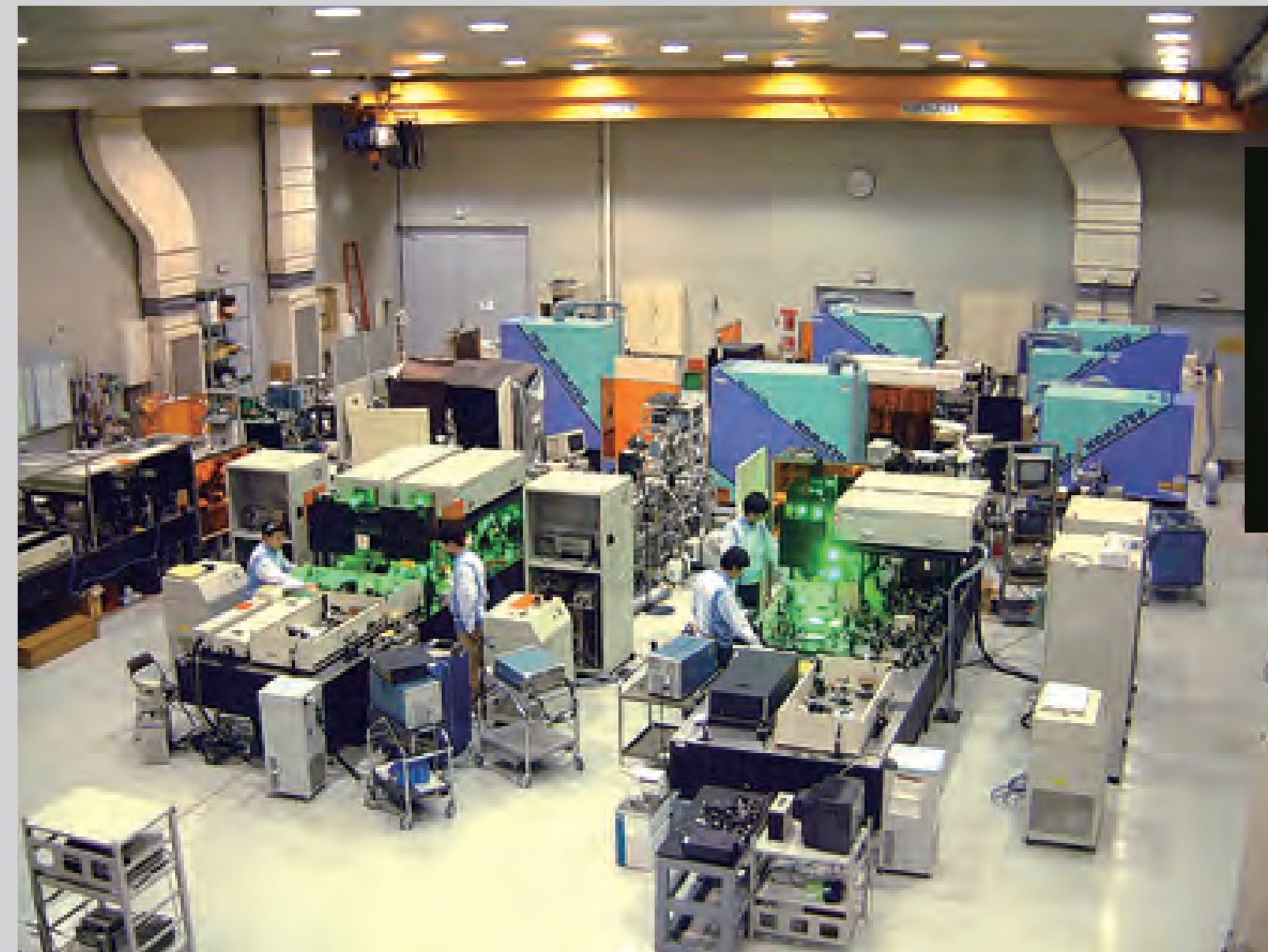
短波長極限光 高出力チタンサファイアレーザーの高次高調波による軟X線光源。
