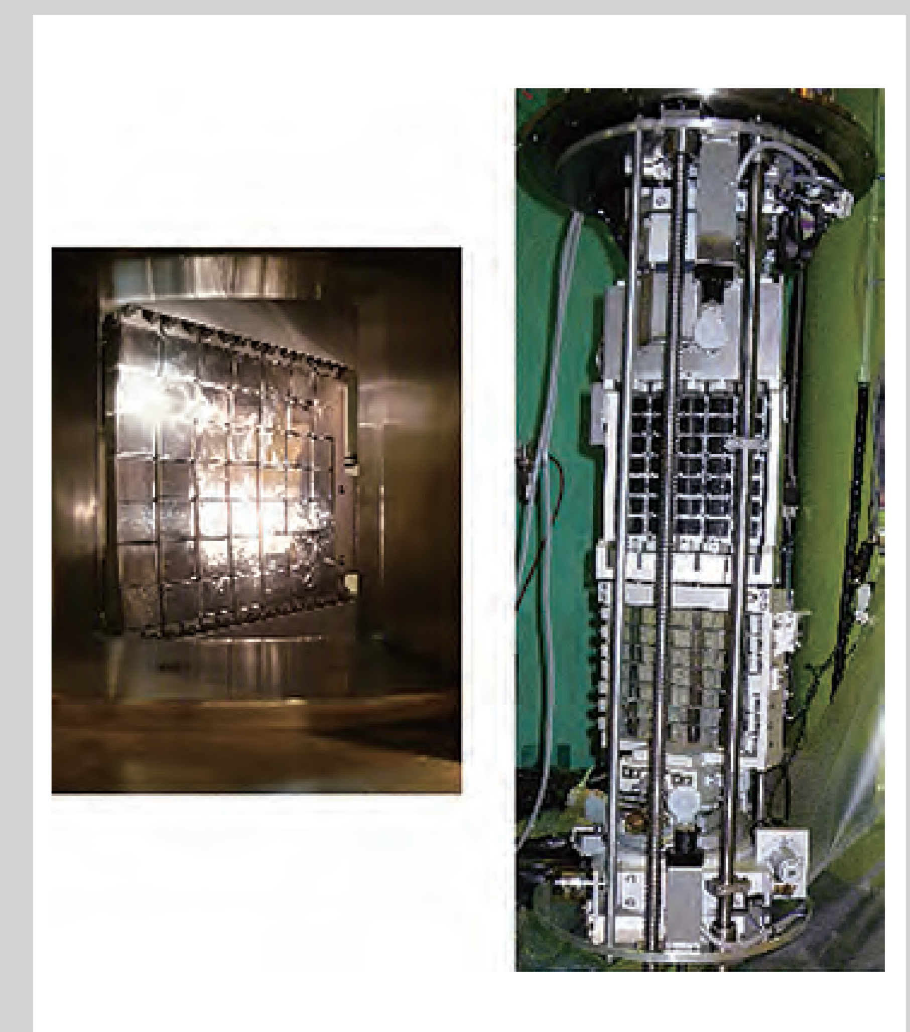
中性子散乱用2方向フォーカシングアナライザー、モノクロメータ。 Doubly focusing analyzer and monochromator for neutron scattering.
