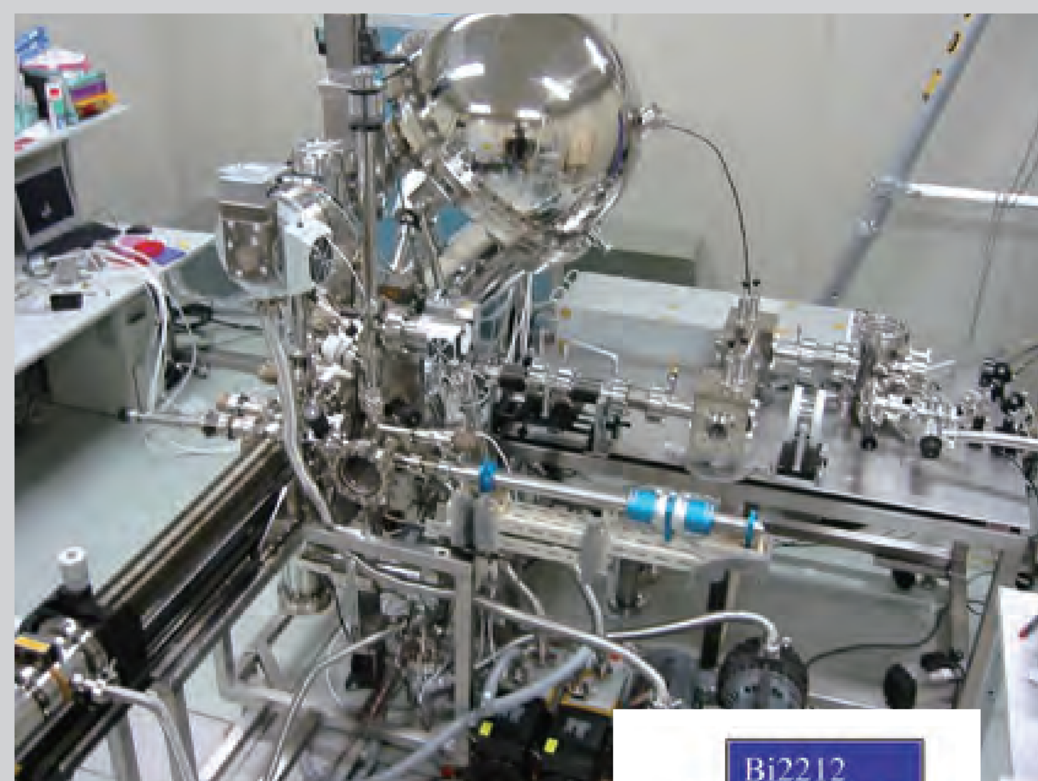
光電子分光 世界最高の分解能を持つレーザー光電子分光装置と高温超伝導体のバンド分散。
