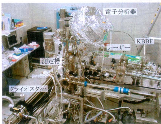
第 3 図 東京大学物性研究所において建設を行った、レーザー励起超高分解能光電子分光装置の全景。
