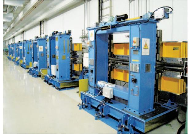
図1 SPring-8 蓄積リング内に設置された8台の水平/垂直偏光型 8 の字アンジュレータ
