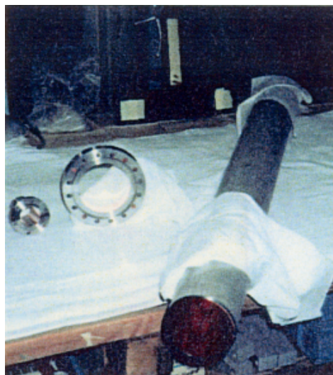
銅メッキチェンバー(溶接前)
