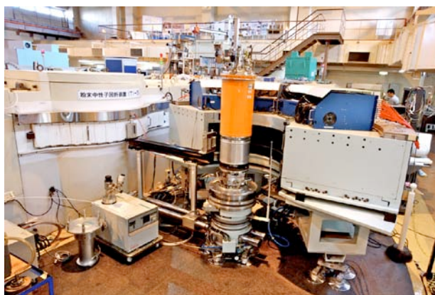
写真 1 : T1-3 HERMES。液体ヘリウム冷凍機を使用中
