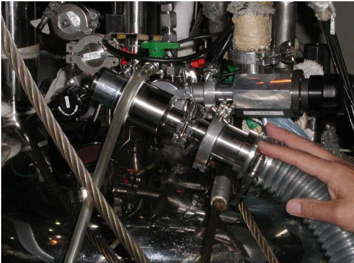
緑のコックがついたパイプにヘリウムガスのボンベとビニールパイプで接続する。
