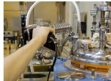
ロー弁を閉じて昇圧弁を開け、供給バルブを開ける。溢れるまで待つて液体窒素容器の供給バルブを閉じて昇圧弁を閉じ、ブロー弁を開けて圧を逃しておく。ドライヤーであたため、または完全に柔ら
