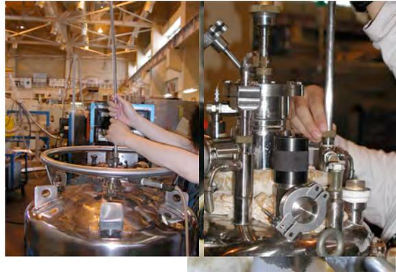
ヘリウム容器の13φくらいのポートに径変換アダプタを取付け、ブロー弁を閉じてからトランス
