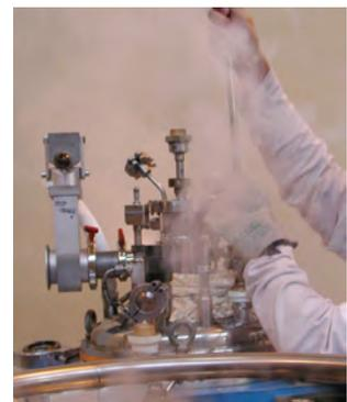
い程度にガスを流す。風船を繋いだ場合は圧力が強くなり過ぎない程度に圧縮を続ける。レベル計が”FULL”になった時点で V2 からの吹き出しが白く強くなり、ここで終了する。レベル計が合っていない場合があるので要注意。まずヘリウムガスを止めて、ホースをはずす。低温作業用の革手袋を着用する。ローレット加工の固定ねじを緩めて双方のチューブの口をひといきで抜く。はしごにのっての作業の場合は転倒しないよう他の人にささえてもらい、十分注意して行うこと。V2、P2、を閉じておく。液体ヘリウム容器は口を蓋してブロー弁を閉じて安全弁の付いたバルブは開けておく。残量計のバルブを開けて、または気柱振動計を用いて液体ヘリウム容器の残量を確認しておく。
