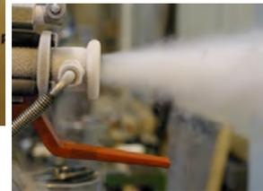
める。分光器に載せている場合はオレンジ本体の供給孔(p2)と同じ高さまでリフターで上げる。**最初のトランスファーの場合**：やや吹き出しが強くなるまで少しずつ液体ヘリウム容器に挿入し、反対側をオレンジ本体の P2 に挿入しすかさず赤いレバーのバルブ (V2) を開ける。V2 からガスが吹き出てくるのを確認する)。液体ヘリウム容器側は容器の底にあたるまで挿入し、オレンジ本体側はなるべく深く挿入する。しっかりチューブをローレット加工の固定ねじで閉める。**継ぎ足しの場合**：液体ヘリウム容器にすこしずつ挿入して行って液面以下までさす。オレンジ本体は P2 のねじを緩めておきすぐ蓋を開けれるようにしておく。反対側の吹き出しが白く強くなったらすかさず P2 に挿入する。なるべく深く挿入すること。すかさず V2 を開ける。物性研オレンジ#2 は12φのトランスファーチューブが入りにくいので細いものにアダプタをつけて使用すると良い。以下、**最初の場合、継ぎ足しの場合共通**：ブロー弁にヘリウムガスボンベまたは風船をつなぎ、静かにブロー弁をあけて、吹き出しが強くなり過ぎな
