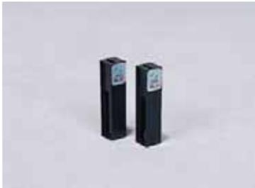
性能試験の項目の中の「波長の正確さ」や「測光正確さ」用校正フィルタとしてJQA(財団法人日本品質保証機構)のJCRMシリーズを取り扱っています。
