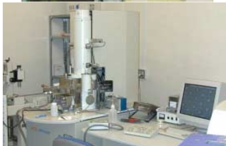
図 3-2 : 電子線描画装置 : L a B。電子源のタイプ (上図) と電界放出型電子源のタイプ (下図)
