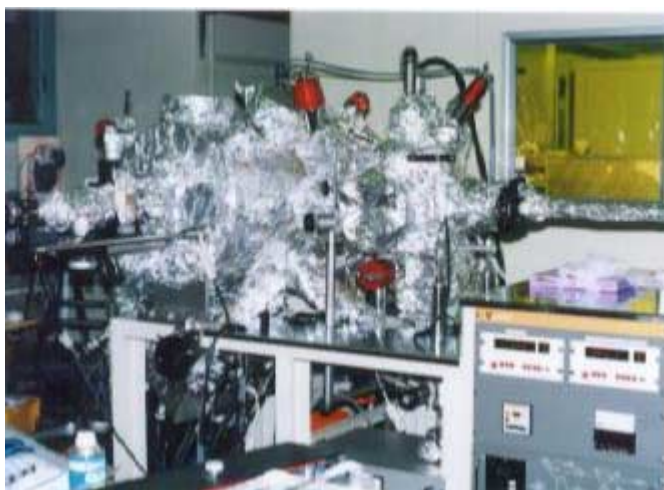
図2-1： - 族希薄磁性半導体専用のMBE装置
