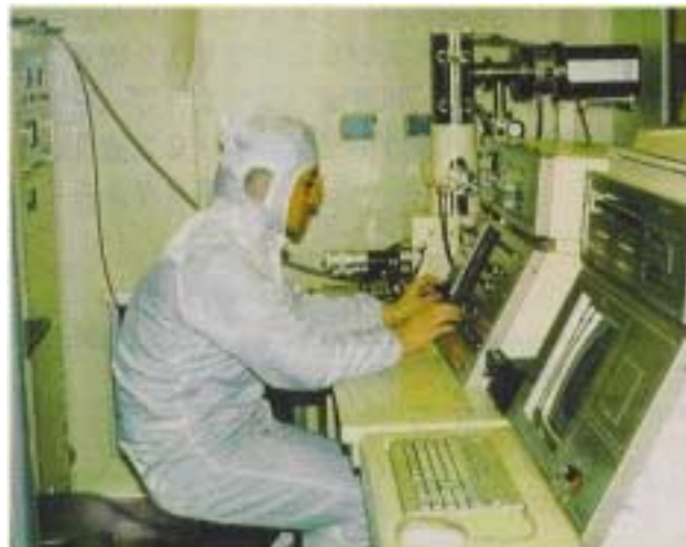
図 3-1 : 高移動度 GaAs/AlGaAs ヘテロ構造試料作製用分子線エピタキシー装置
