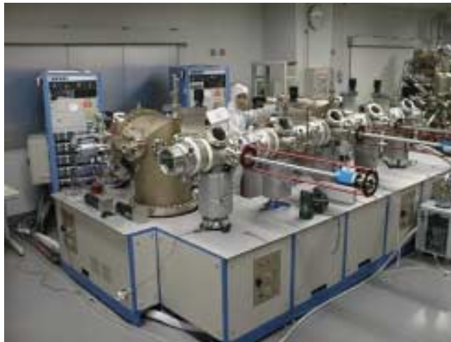
図 3-1 : 高移動度 GaAs/AlGaAs ヘテロ構造試料作製用分子線エピタキシー装置
