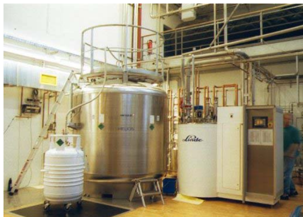
図2. マックス・プランク研究所の液化システム概要
