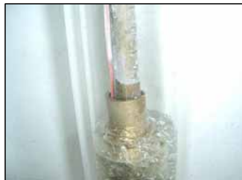
図 8 液体窒素中でのタービンのテスト
