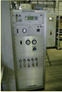
⑬, ⑬-2 Heガス分析計 Linde社製 O 2 , H 2 O, CxHy, N 2 検出可能
