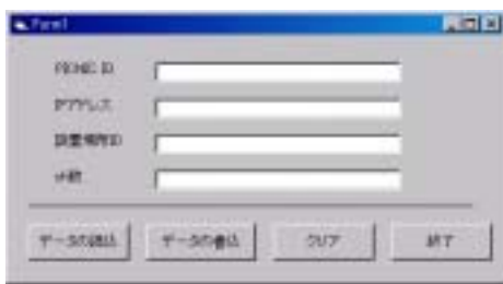
図5. シリアル・イーサネット変換マルチプレクサの設定画面
