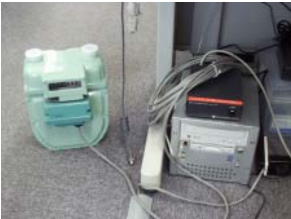
図 3. テレメカウンタ付き N 型ガスメータ(左)と I/F BOX(右上)
