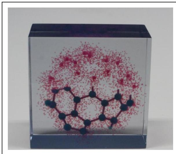
図2 3Dプリンタで透明樹脂中に形成した、フラーレン(C<sub>60</sub>)の電子雲を描写した分子模型(5cm角)。ドットが電子雲。下半分は従来のボールスティックタイプの分子模型(ボールが炭素原子、スティックが原子間結合)を電子雲に重ねて描写している。フラーレン(C<sub>60</sub>)は炭素の12個の5員環と20個の6員環から成り立っており、6員環の3辺は2重結合であると説明されているが、実際の電子雲は各炭素原子核周囲に均等に分散していることが本模型より理解できる。
