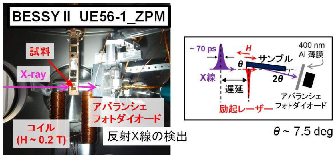
図1：時間分解磁気円二色性測定のセットアップ。
