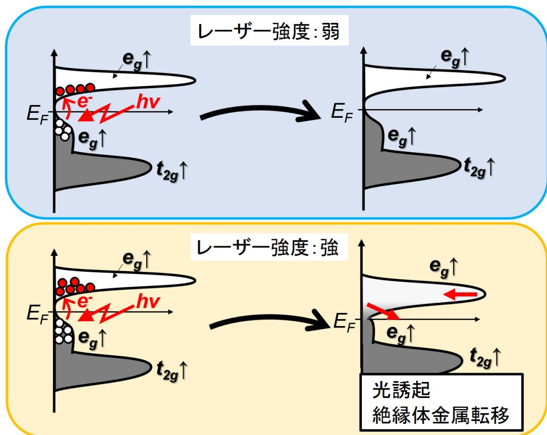
図3：レーザーによる絶縁体金属転移のメカニズム。
